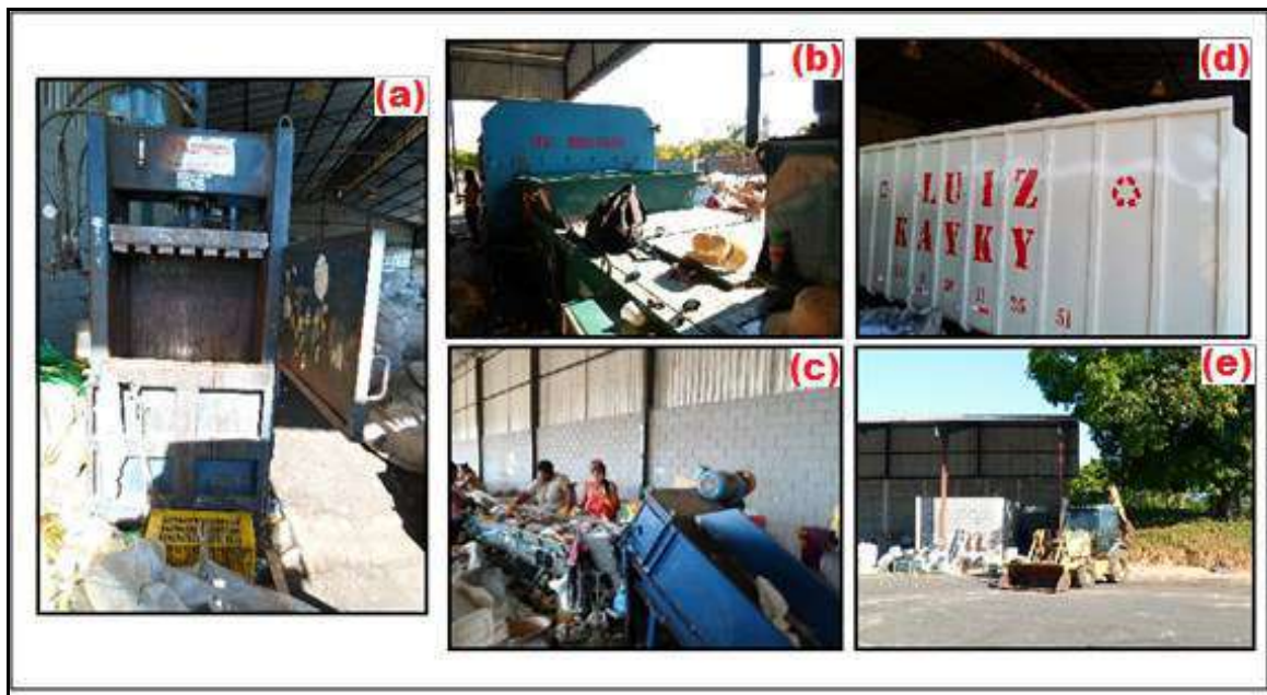
Figura 103 - Equipamentos da Central de Materiais Recicláveis: a) prensas hidráulicas; b) basculante com prensa interligada; c) esteira; d) caçambas basculantes; e) retroescavadeira.
