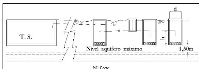
Figura 19 - Esquema da Distribuição de Sumidouros como polimento dos efluentes de Tanque Séptico ou Fossa Biodigestora.
